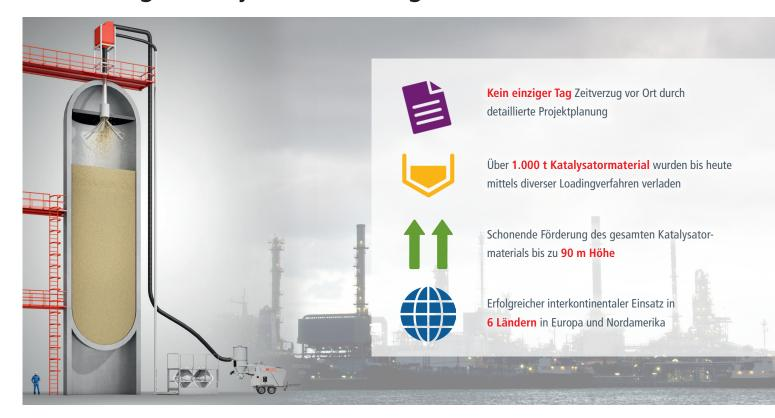
Überzeugende Vorteile machen den Unterschied: Exakte Dosierung und kontinuierliches Fördern des Materials ohne die Gefahr schwebender Lasten
